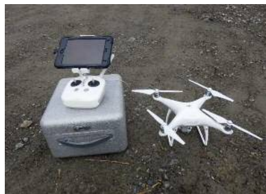
UAV（ドローン）による起工測量
