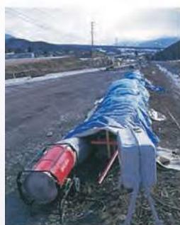
ダクトタイプヒーター使用方法 (ダクトの折れ曲がりにご注意ください)
